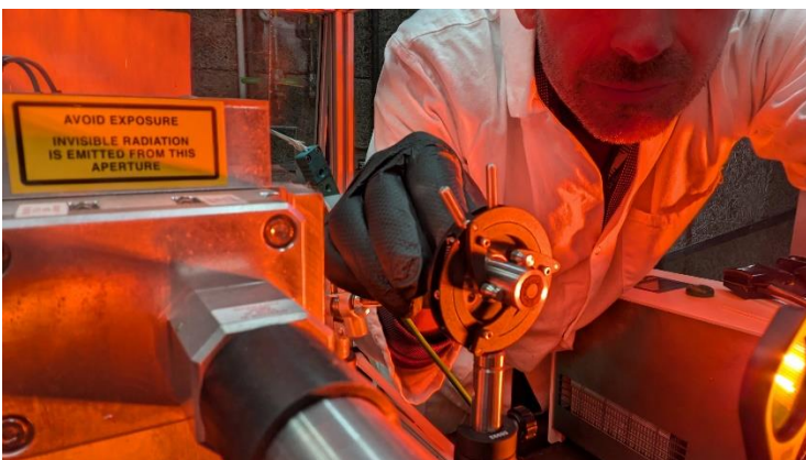
Figure 2 Capteur IHF au travail sur banc de calibration laser. NexTherm Sensing est le seul fournisseur de capteurs de flux thermique utilisant le laser comme source de calibration stable et précise.
